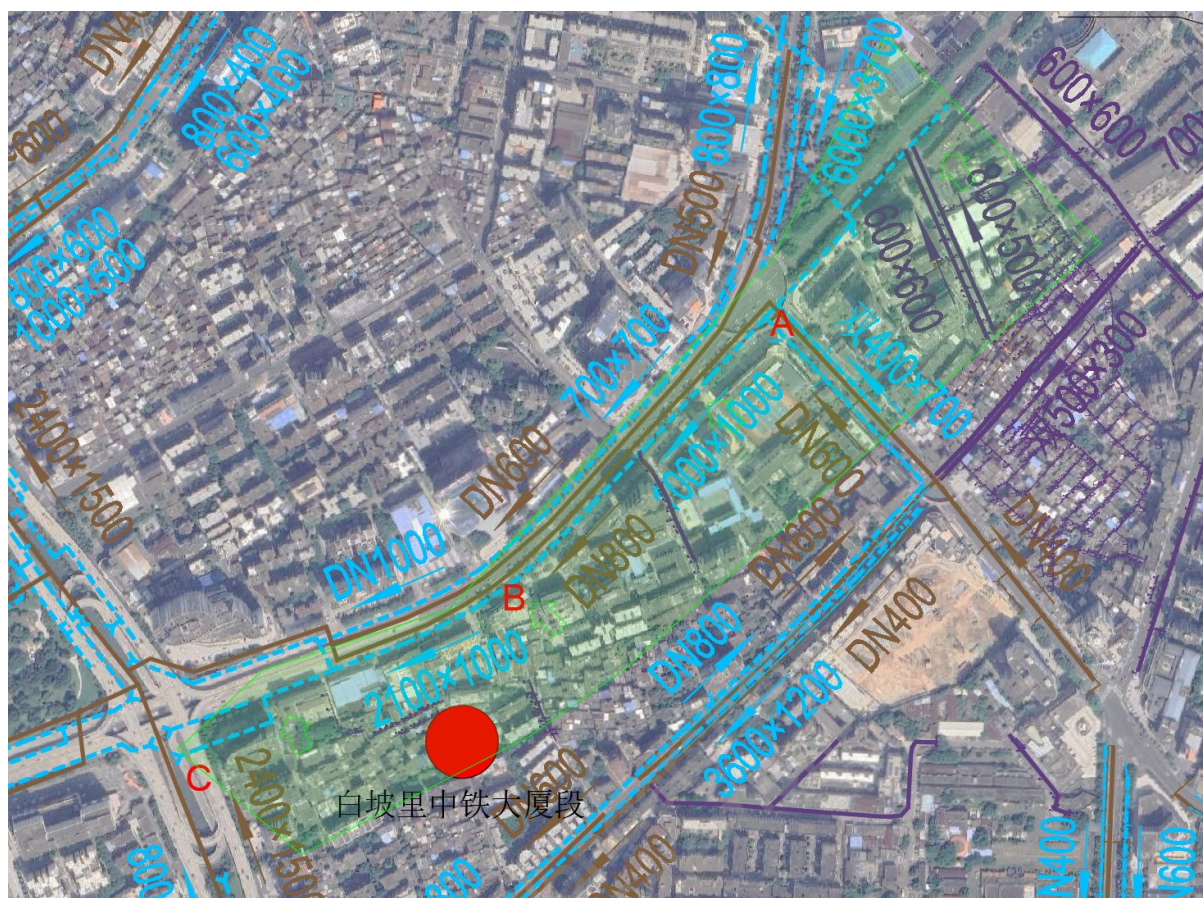
图 5-10 中铁大厦积淹点汇水范围图
