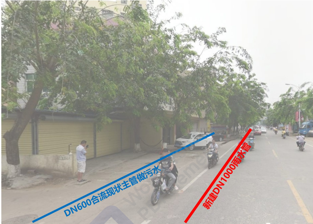
图 5-6 晋江村新建雨水管敷设示意
