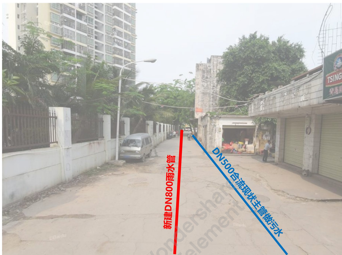
图 5-3 仙桥一里雨水管敷设示意图
